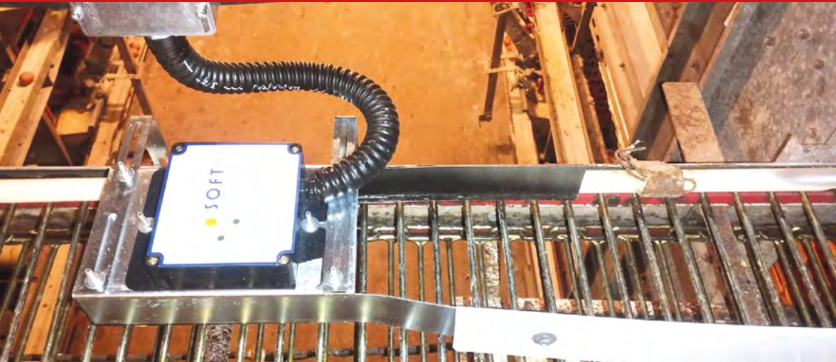
O CONTADOR DE OVOS DA SOFT E SEU CRIADOR, FÁBIO MASSARA (ao lado): precisão de dados oferecido pela tecnologia é de 99,98%, garante.
