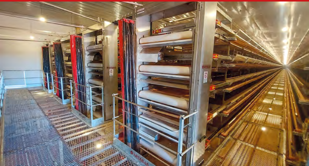
A PASSARELA: item fundamental nesse tipo de aviário, com plataforma na área externa para abastecimento de aves no período de alojamento e desalojamento.
