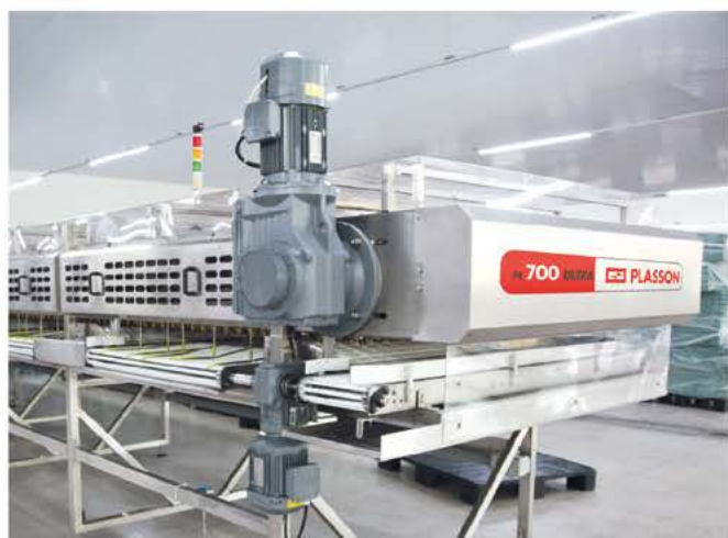
Classificadora PL 700 ULTRA Capacidade até 700 caixas/hora
