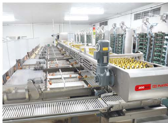
Classificadora PL 200 PLUS Capacidade até 200 caixas/hora
