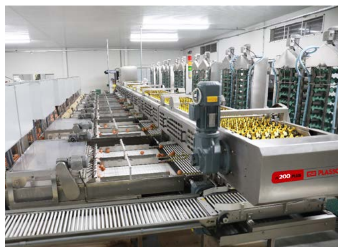
Classificadora PL 200 PLUS Capacidade até 200 caixas/hora
