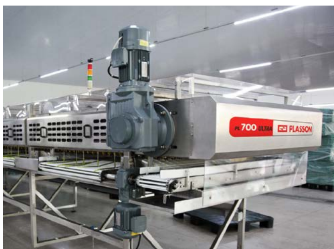
Classificadora PL 700 ULTRA Capacidade até 700 caixas/hora
